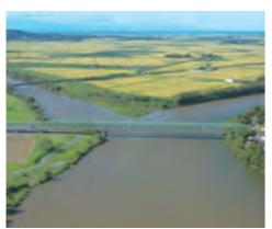
北上川改修の象徴的な地。伊達政宗公の家臣川村孫兵衛が実施した現在の旧北上川・旧迫川・江合川の付替工事によって下流域の洪水被害が激減し新田開発が活発になり、江戸に米を輸送する水上輸送網が確立されました。
