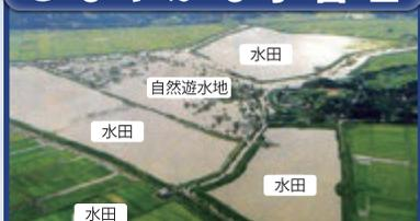
水田を組み合わせた遊水地を設け、周辺の浸水被害を軽減
