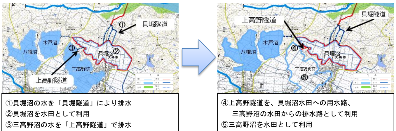
図 2-11 湿地の水田利用と隧道・潜穴を活かした用水と排水の知恵
